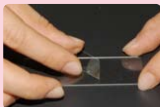
④気泡が入らないように注意しながら、カバーガラスをかける。
